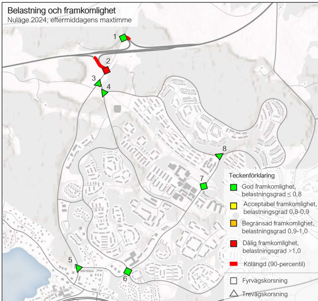
Figur 17. Belastning och framkomlighet under eftermiddagens maxtimme i korsning 1–8, nuläge 2024. © Lantmäteriet
